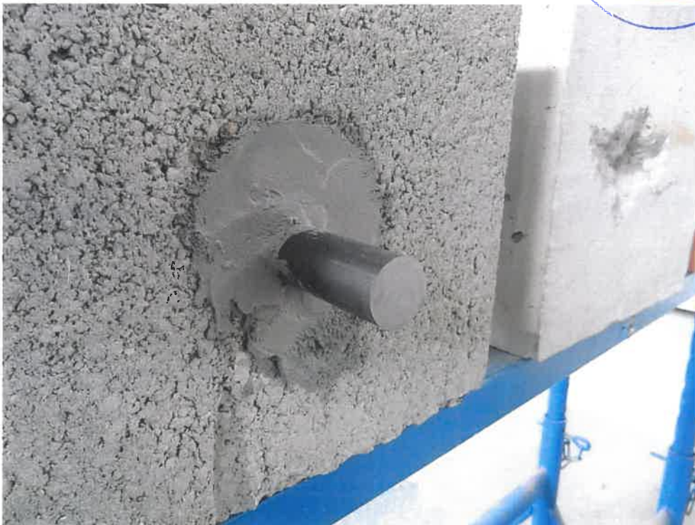
Bild 6 Überarbeitung der Ausbruchstellen unter Verwendung eines Rundstahls zur Gewährleistung des Bohrlochdurchmessers
