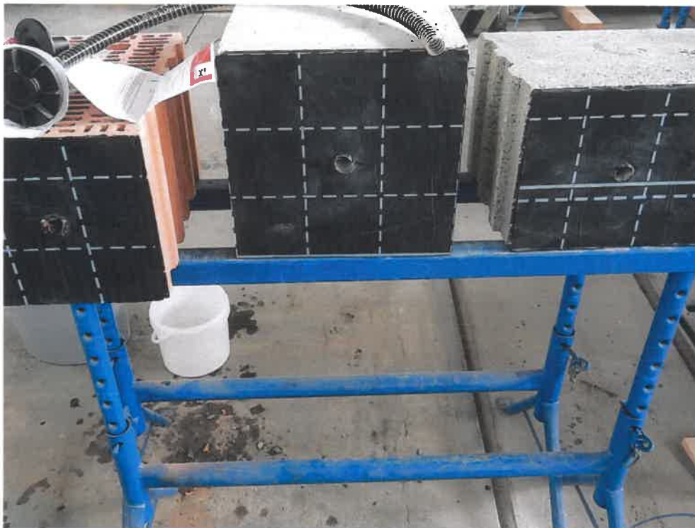
Bild 7 Probekörper mit KSK nach Herstellung der Bohrlöcher
